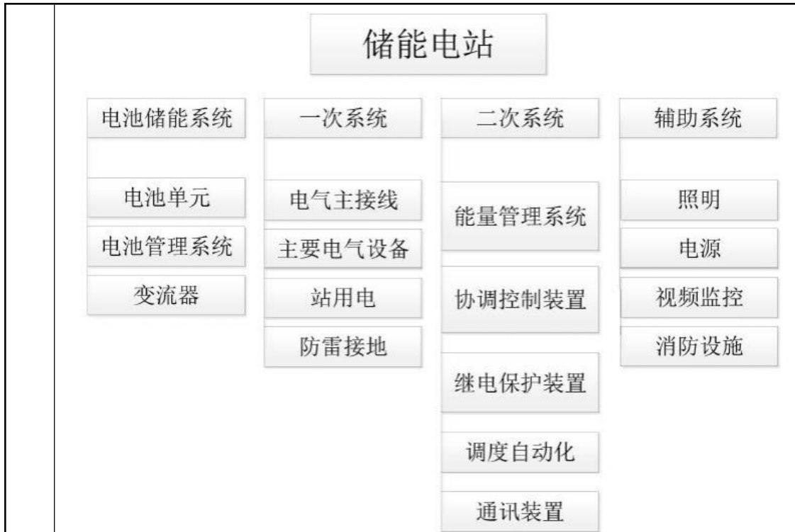
图2-1 储能电站系统架构图
