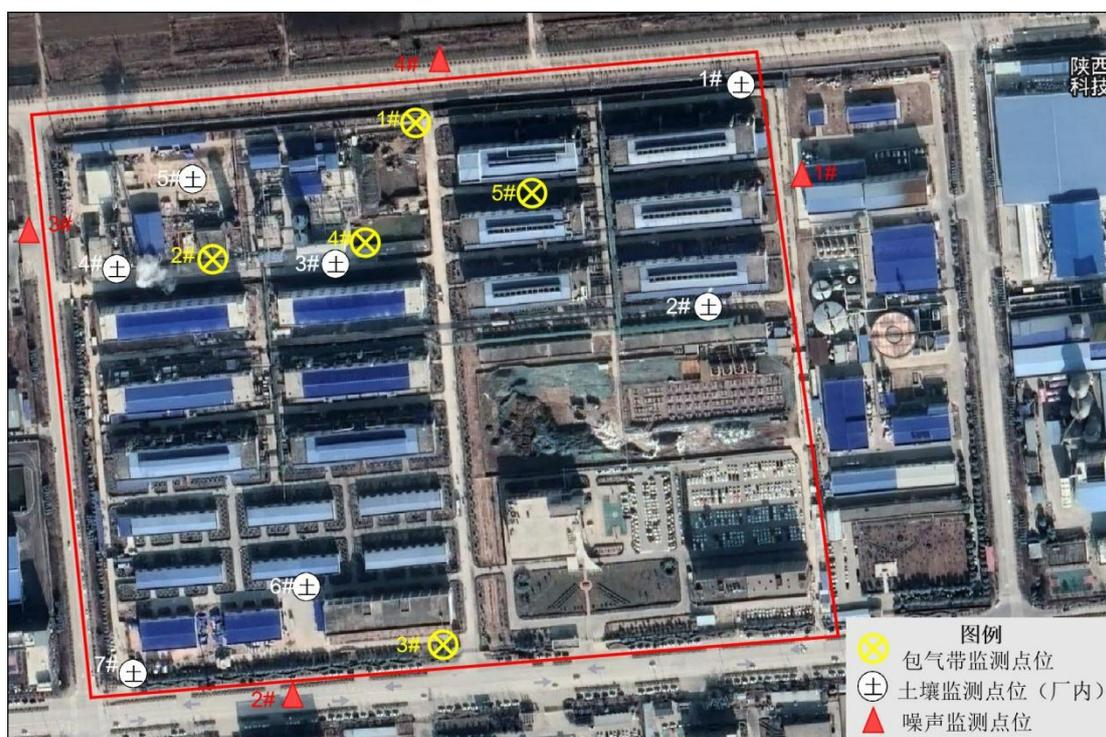
图 4.4-2 包气带、噪声、厂内土壤现状监测点位图
