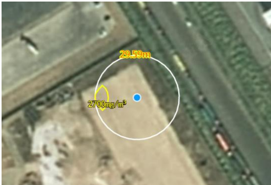
图 6.8-1 最不利气象条件下醇基燃料泄漏预测结果图
